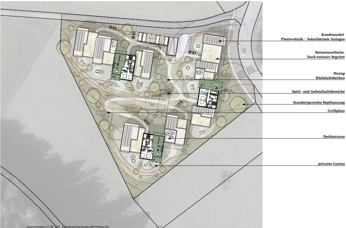
Abbildung 4 - DG Freiraum / Energie / Nachhaltigkeit 1:500
